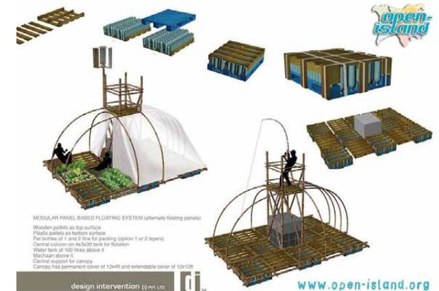
Das Open-Island Bausystem basierte zunächst auf Plastikflaschen und Holzpaletten in einem rechteckigen Raster. Seit 2018 besteht Open-Island 2.0 aus sechseckigen Modulen, die auf upgecyclten Abfallcontainern schwimmen.
